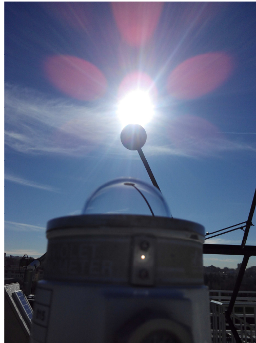
Sensor de UVB en difusa (en sombra) en la estación del CRN
