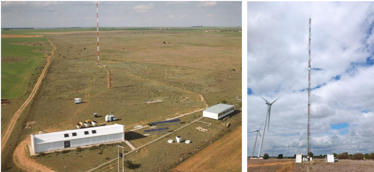
Figura 2. Derecha: Instalaciones del CIBA, con torres instrumentalizadas de 100 y 10 m de altura y laboratorios científicos. Izquierda: Torre de observación con tomas de muestras de GEIs y sensores meteorológicos a 10 m, 50 m y 100 m sobre el nivel del suelo, junto con contenedor científico en la base a la derecha de la imagen.
