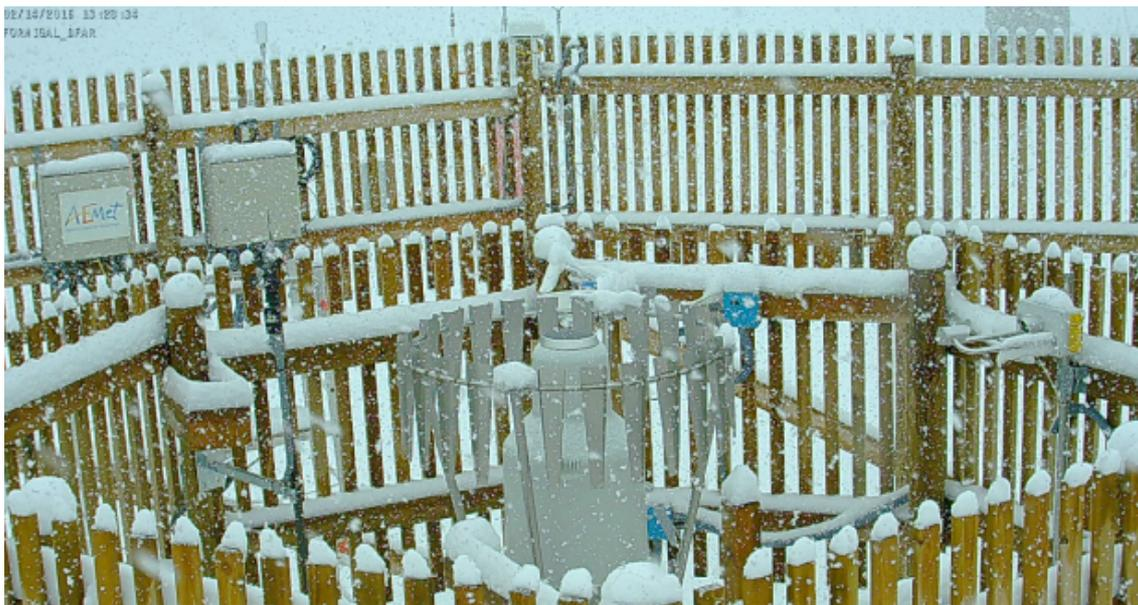
Figura 2. Interior del DFAR de Formigal-Sarrios, con el pluviómetro de pesada y el sensor de tiempo presente (disdrómetro) en el interior del anillo central.
