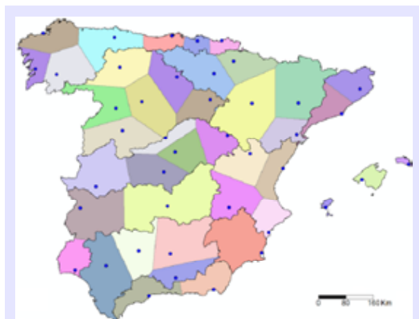
Figura 5. Áreas representativas de cada una de las 42 estaciones de referencia para la asignación de los pesos en el cálculo de la temperatura media de la España peninsular y Baleares.
