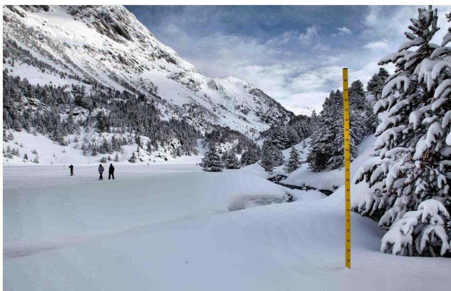
Figura 69. Jalón nivométrico graduado en Llanos del Hospital
