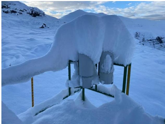
Figura 64. Pluviómetro colapsado en el refugio de Góriz
