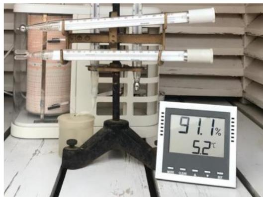
Figura 35. Termohigrómetro digital en garita. Fuente: AEMET
