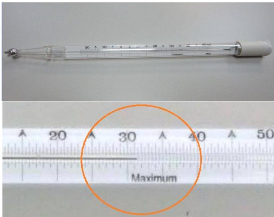
Figura 32. Termómetro de máxima. En la imagen inferior, se aprecia una temperatura máxima de 31.3 °C. Fuente: AEMET
