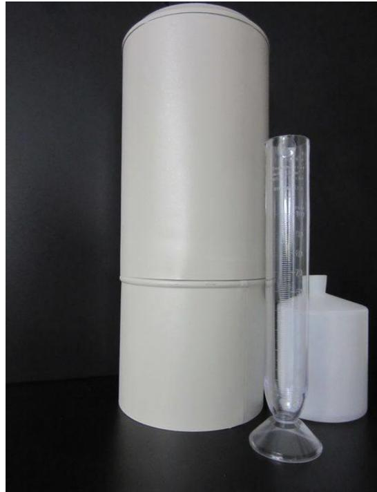
Figura 59. Pluviómetro manual de tipo Hellmann utilizado en AEMET. Fuente: imagen izquierda, AEMET; imagen derecha, Meteoglosario visual AEMET
