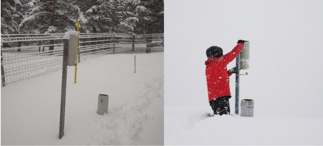
Figura 65. Intercambio de pluviómetros a la hora de la observación en las estaciones de Valdelinares (izquierda) y del refugio de Bachimaña (derecha).
