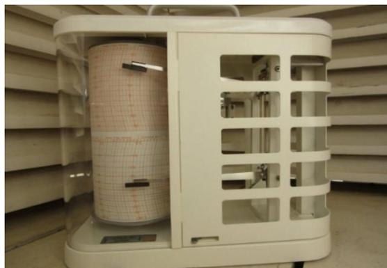
Figura 36. Termohigrógrafo. Fuente: AEMET
