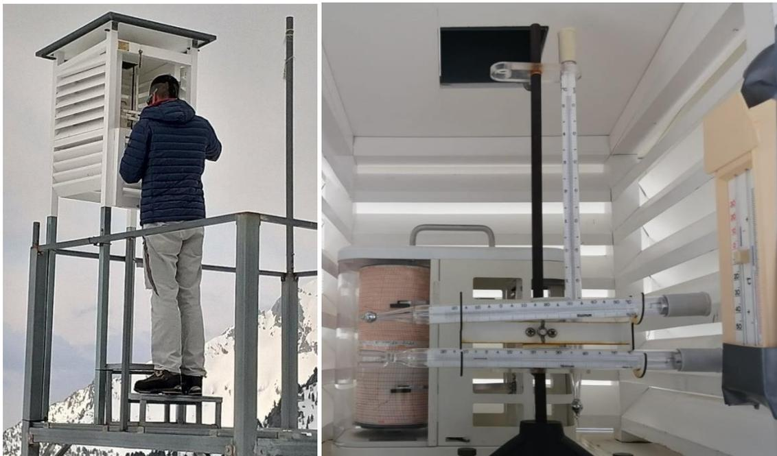
Figura 3. Garita meteorológica e interior con instrumentos en el refugio de Bachimaña
