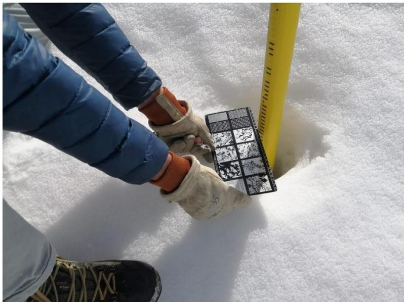
Figura 72. Medida correcta del espesor de nieve en el refugio Cap de Llauset
