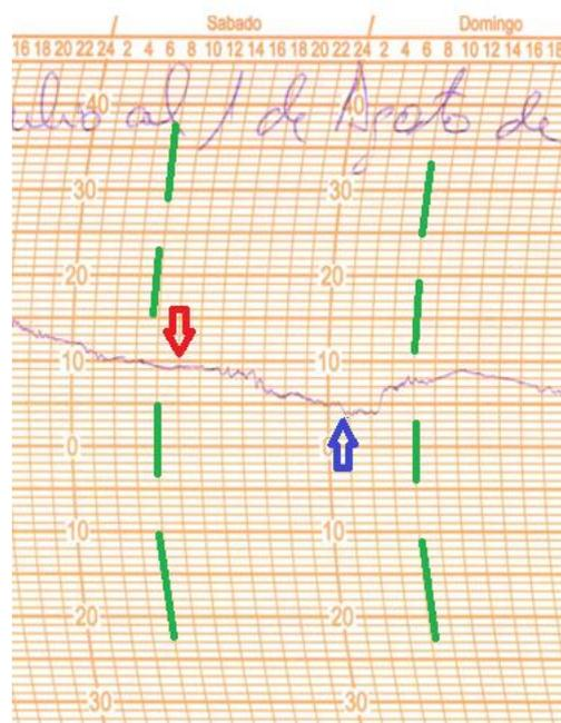
Figura 38. Tramo de 08 a 08UTC de la banda del termohigrógrafo de Ángel Orús de la Figura 37
