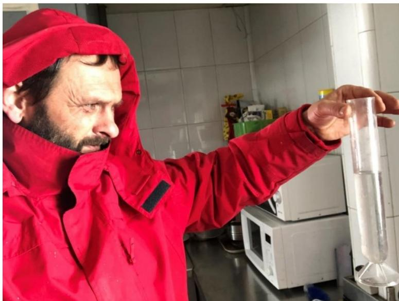
Figura 61. Medida de la precipitación en una probeta graduada por el guarda del refugio Ángel Orús
