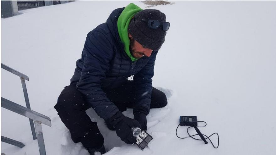
Figura 80. Proceso de observación de tipos de granos con placa granulométrica y lupa en el refugio Cap de Llauset
