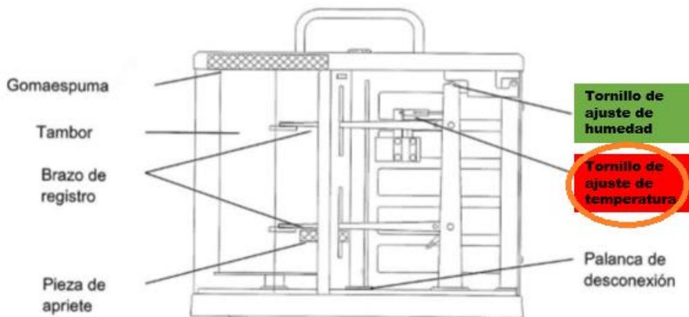
Figura 42. Tornillo de ajuste de temperatura. Fuente: AEMET
