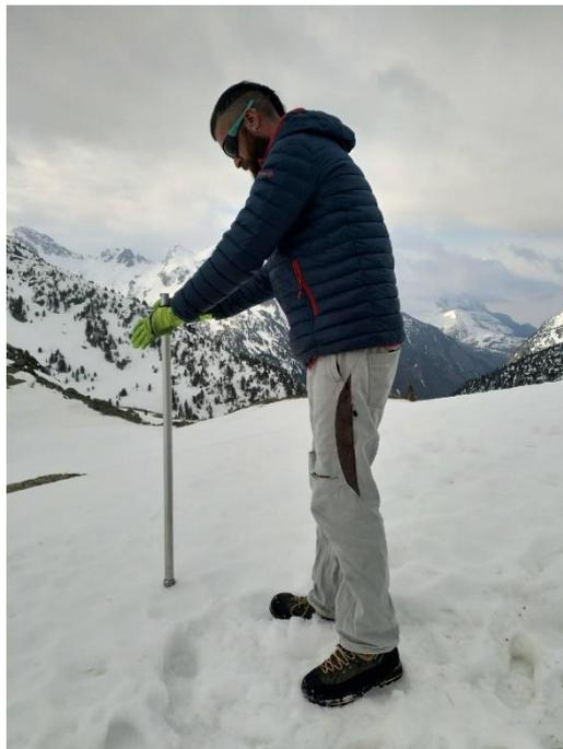
Figura 77. Procedimiento de medida del hundimiento del primer tubo de la sonda por golpeo realizado en el refugio de Bachimaña
