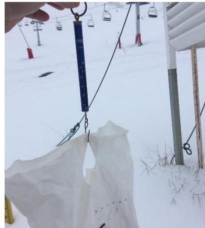
Figura 88. Tubo de densidad relleno de nieve y proceso de pesado en Candanchú.
