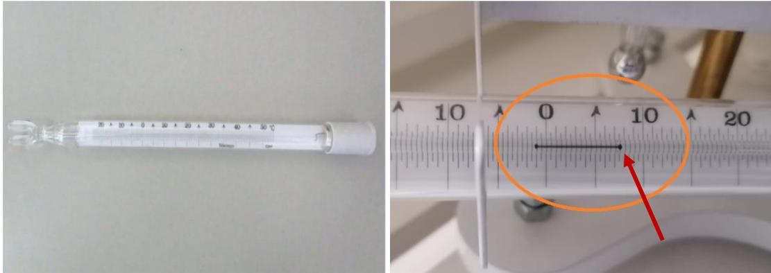
Figura 33. Termómetro de mínima. A la derecha se observa el índice. La temperatura mínima que marca es de 7.7 °C, correspondiente con la posición del extremo derecho del índice, el más alto de los dos extremos y el más alejado del depósito. Fuente: AEMET
