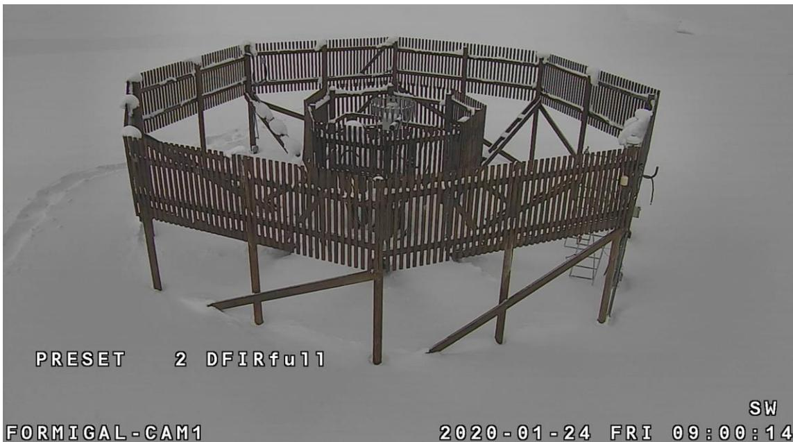
Infraestimación. Pluviómetro protegido por doble vallado para limitar el efecto del viento sobre el copo precipitante y poder comparar con el pluviómetro habitual sin protección, que en episodios de nevadas mide menos cantidad de precipitación en general. Webcam de AEMET en Formigal
