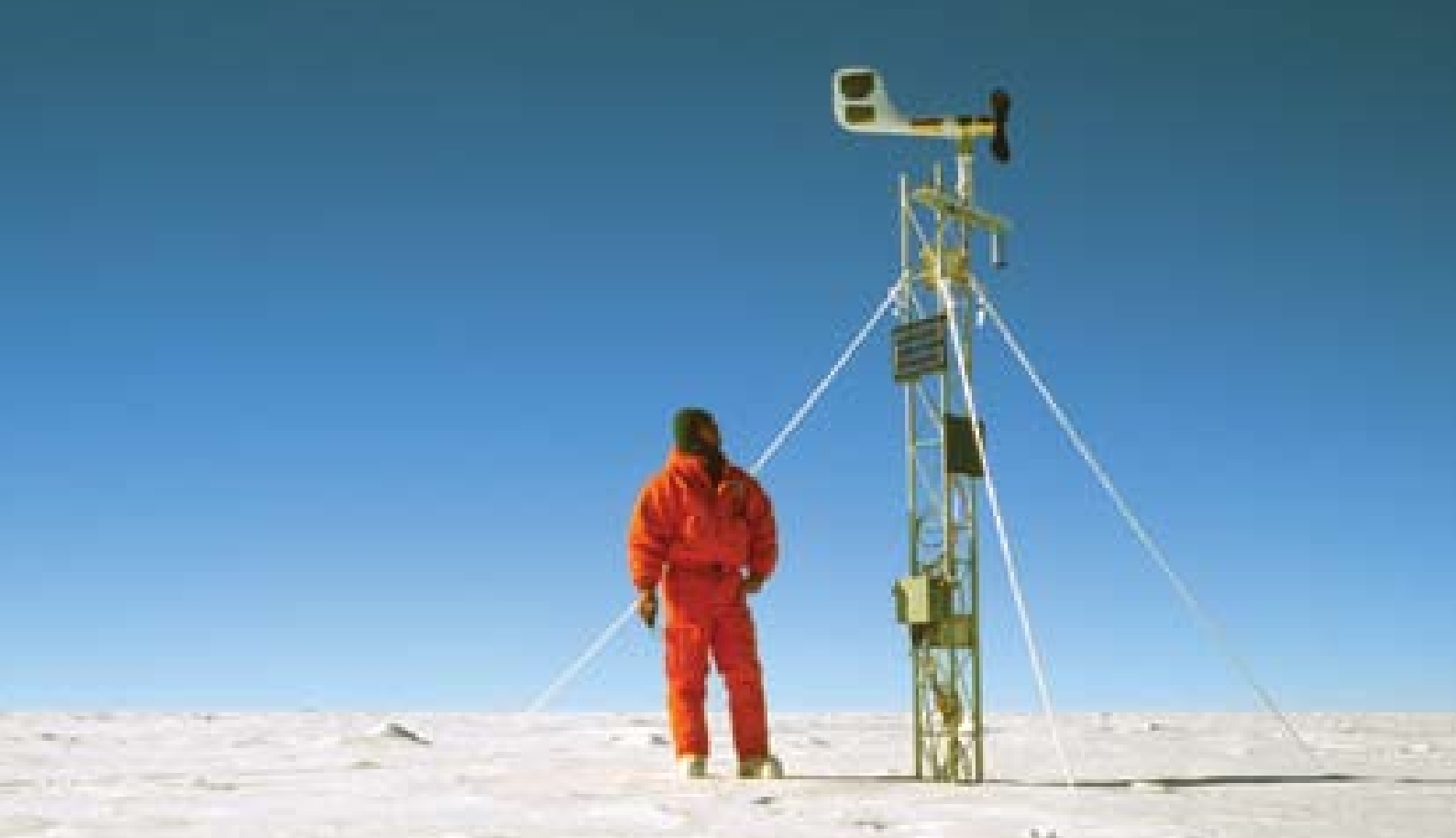
Estación meteorológica automática en la Antártida
