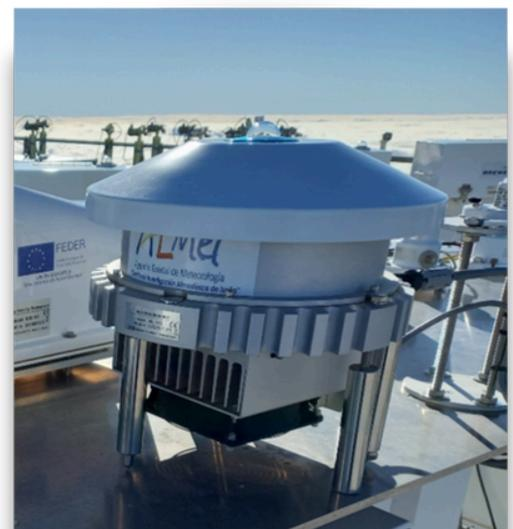
Fig. 5.6- Espectroradiómetro EKO MS-713
