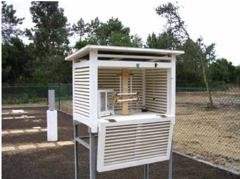
Fig. 3. Garita meteorológica y pluviómetro de la estación climatológica de Viana do Castelo. Abrigo meteorológico e udómetro da estação climatológica de Viana do Castelo. Meteorological screen and rain gauge at the station of Viana do Castelo.
