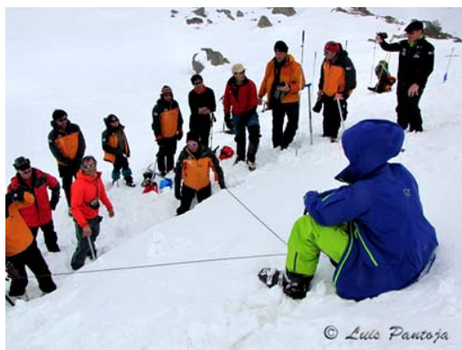
Fig. 80 Corte para el test de cuña deslizante
