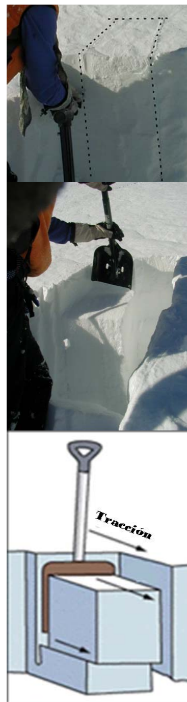
Fig. 74 Test de la Pala.
