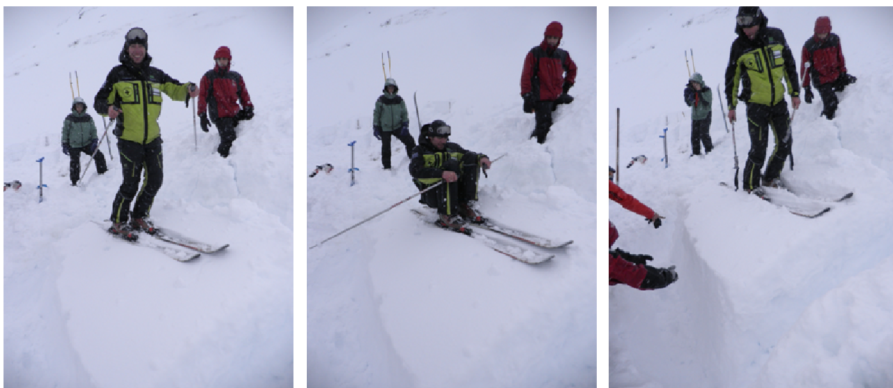
Fig. 78 Test Rutschblock, carga de un bloque
