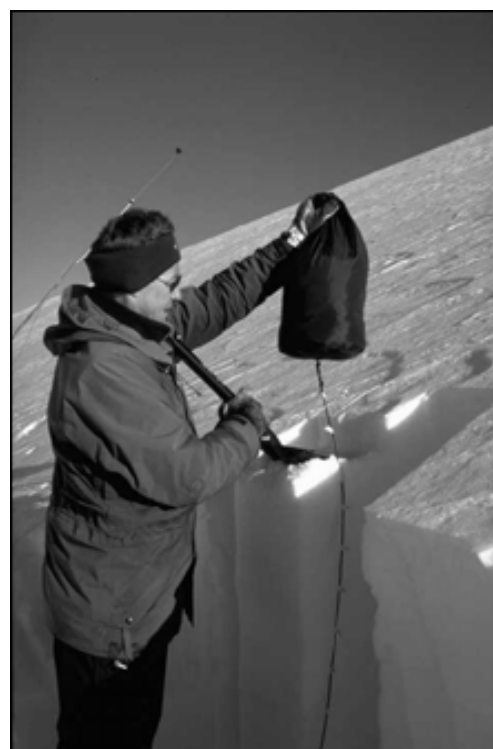
Fig. 79 Test Stuffblock o del peso
