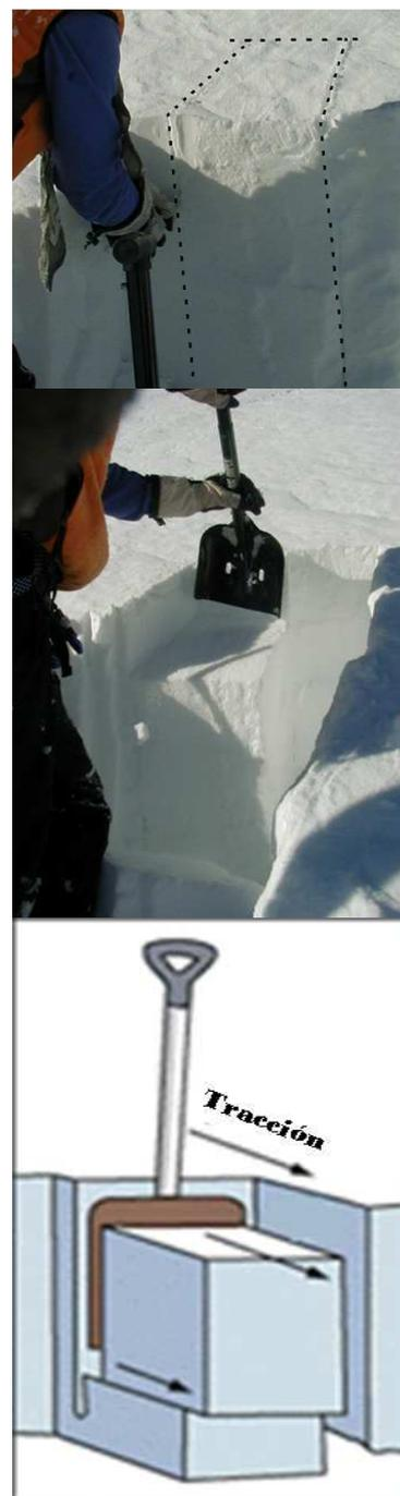
Fig. 73 Test de la Pala.
