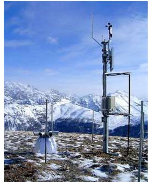
Fig. 33 Driftrómetro y flowcapt
