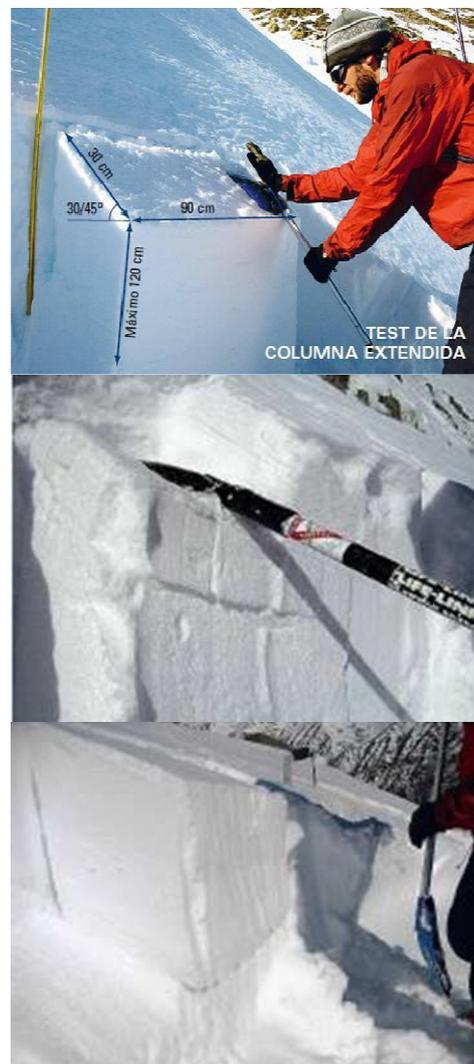
Fig. 75 Test de la Columna Extendida
