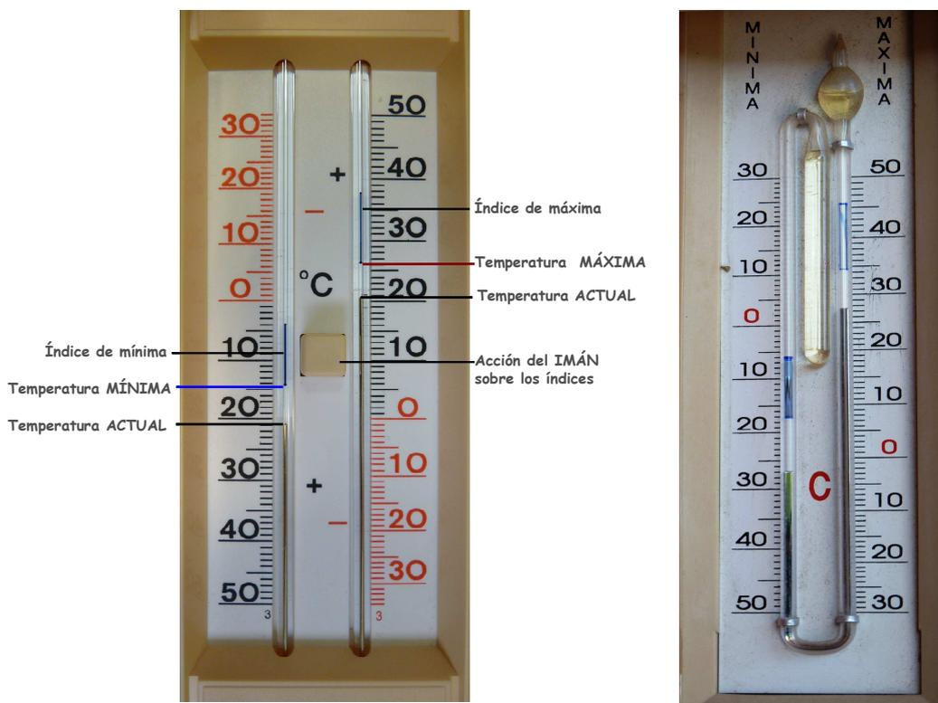
Fig. 25 Termómetro Six-Bellani: detalle de lecturas y estructura
