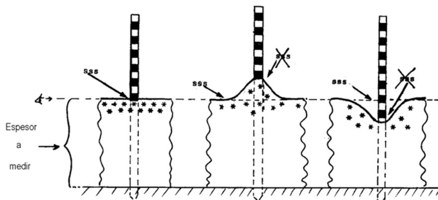
Fig. 31 medida del espesor de nieve
