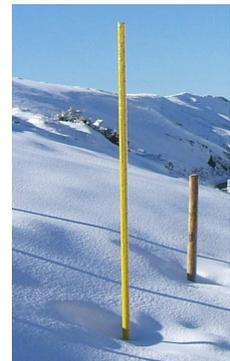
Fig. 30 Jalón nivométrico
