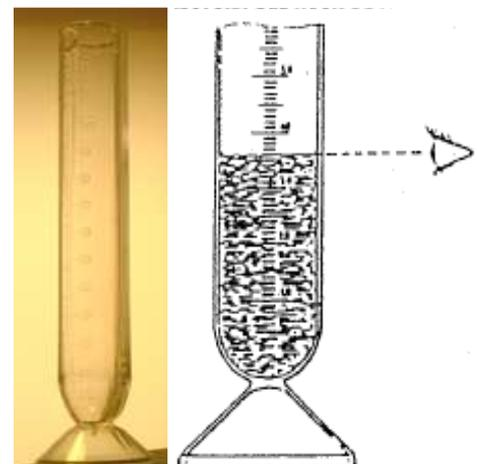
Fig. 29 Probeta del pluviómetro y lectura
