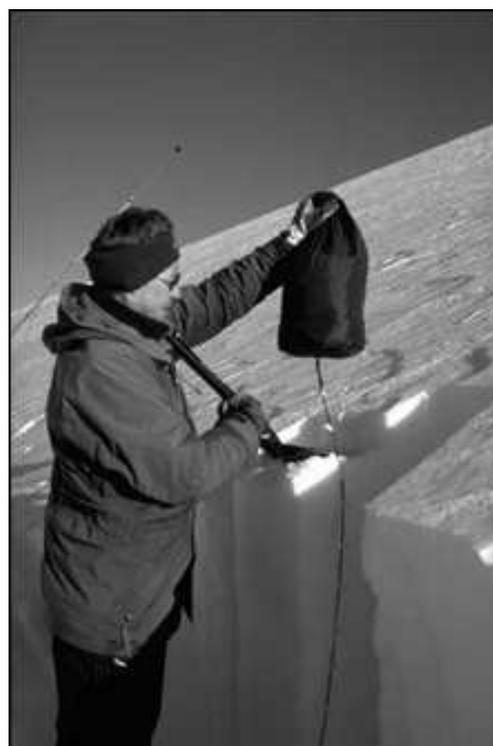
Fig. 78 Test Stuffblock o del peso
