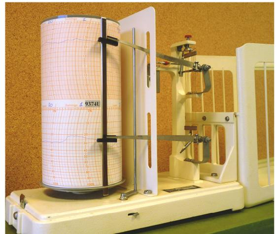
Fig. 26 Termohigrógrafo
