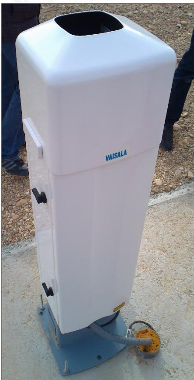
Ceilómetro CL31 para determinar la altura de la base de nubes
