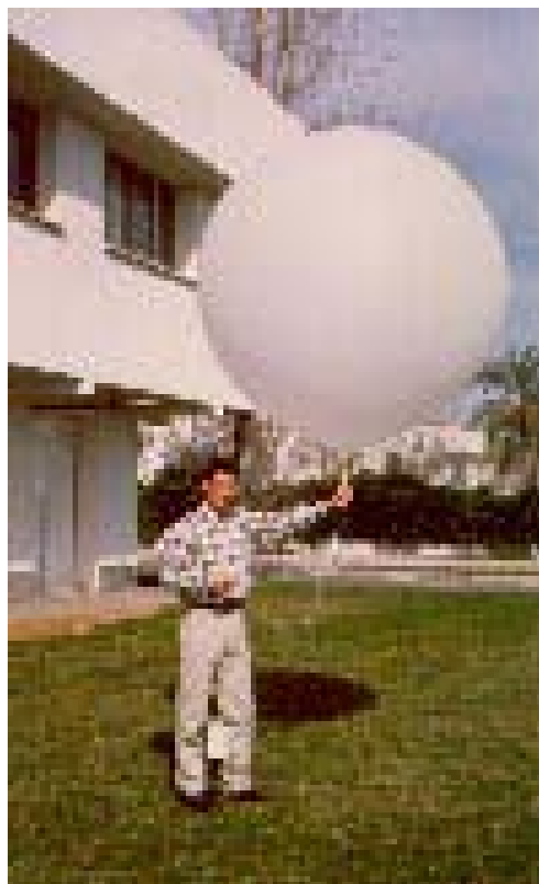
Lanzamiento de radiosonda
