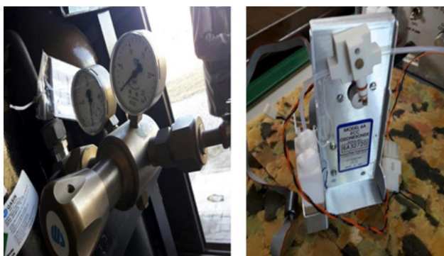
Figura 4. Izda. Manómetros para controlar la presión de referencia y la presión del globo de Helio; Derecha: Sonda especial para medir el ozono en la atmósfera.
