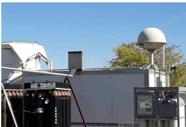
Figura 1. Lanzador de sondas convencionales de VAISALA, con la rueda de 24 globosonda preparados.
