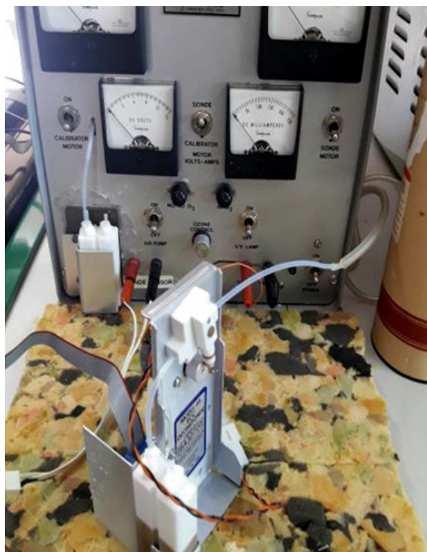
Figura 5. Sistema para calibrar la sonda para medir el ozono en la atmósfera comparando las medidas con la referencia
