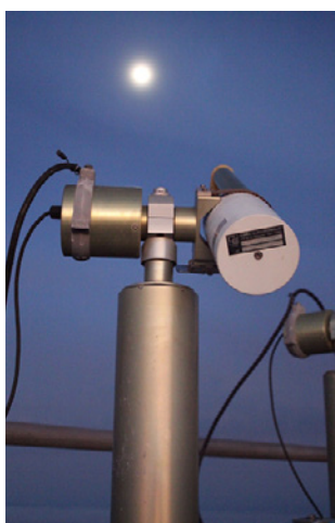
Foto 2: Izquierda, fotómetro CE318T (sun-sky-moon) de la red AERONET midiendo a la luna. Foto 3: Derecha, investigadores del Grupo de Física de la Atmósfera, Univ. Granada, y Grupo de Óptica Atmosférica, Univ. Valladolid, midiendo con un fotómetro estelar.
