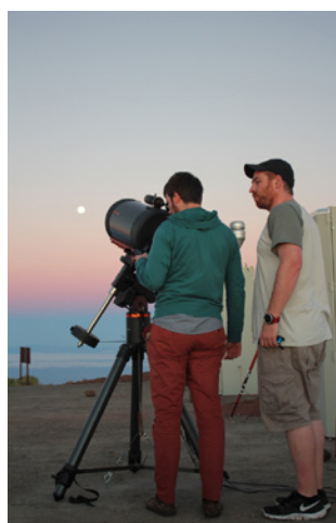
Foto 2: Izquierda, fotómetro CE318T (sun-sky-moon) de la red AERONET midiendo a la luna. Foto 3: Derecha, investigadores del Grupo de Física de la Atmósfera, Univ. Granada, y Grupo de Óptica Atmosférica, Univ. Valladolid, midiendo con un fotómetro estelar.
